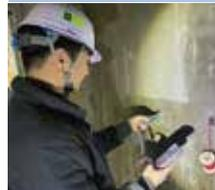
측정 및 시험장비를 통해 시설물의 주요 부재와 강재 상태를 조사하고 구체적인 관리 방안을 제시합니다.
